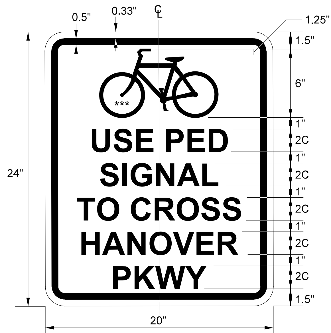
DETAIL 'M' - R3-6(MOD) N.T.S.
